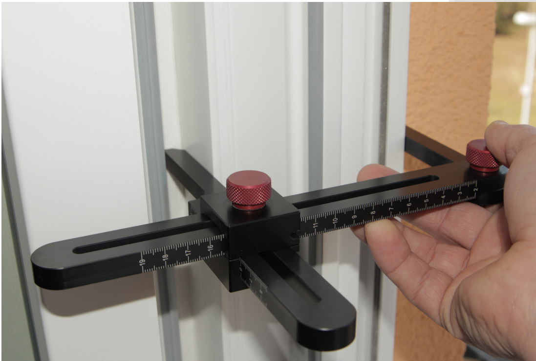
Das Aufmaß ist auch bei geöffnetem Fensterflügel möglich
